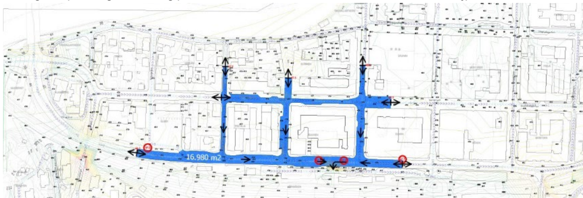
Exempel på en dagvattenanalys som visar placeringen och kapacitetsbehov för dagvattenhantering.
